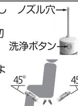
⑦ 使用後はノズル内部に水が残っていますので水抜きをします。ポンプを30回動かしてタンク内の圧力を上げ洗浄ボタンを押し噴射するとノズル内の水が出て無くなります。
