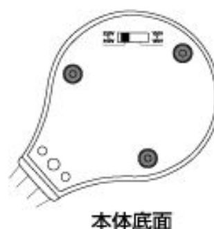
電圧切替スイッチ
