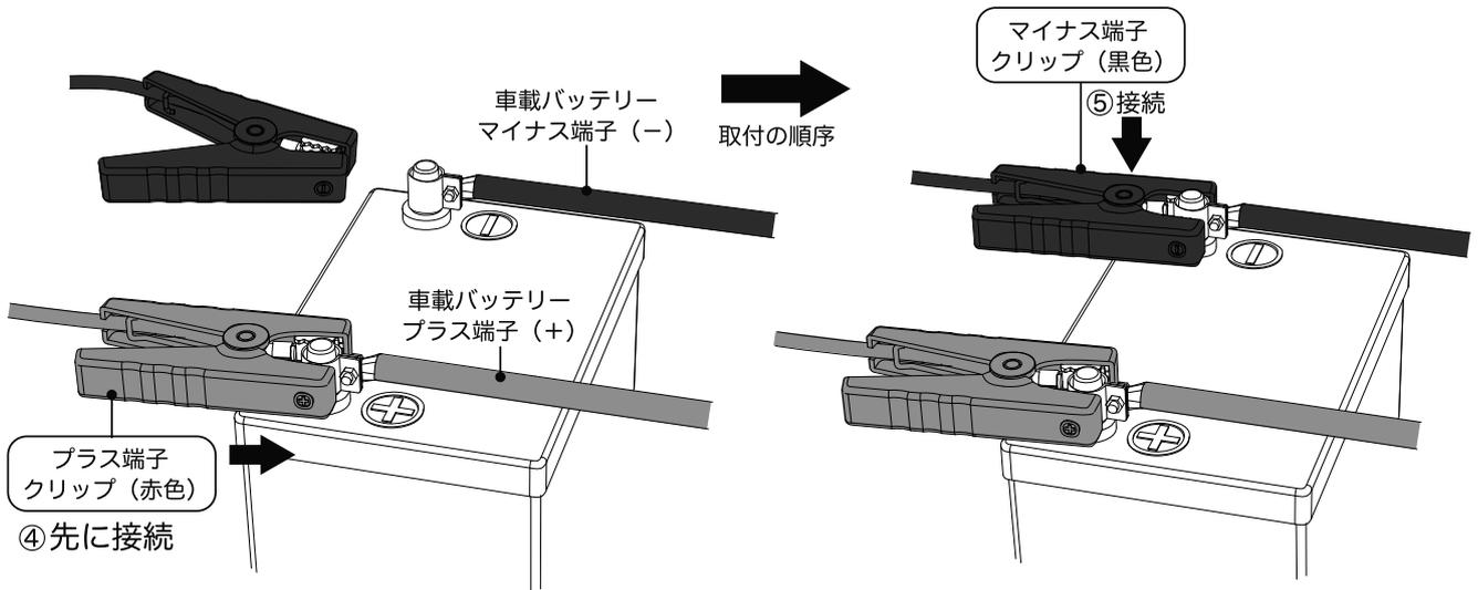
端子クリップ接続後、保護回路ボックスの赤 LED が点灯もしくは点滅しブザー音が鳴った場合、保護機能が働いている状態です（ショート保護 / 逆接続保護 ※逆流保護のみ 緑 / 赤 LED が両方点灯しブザー音）。端子クリップを車載バッテリーから取り外し、製品本体からジャンプスタートケーブルを取り外すことで、保護機能がリセットされ、ブザー音がストップします。取り外し後、ショート / 逆接続を行っていないかを確認いただき、再度手順通りに接続を行ってください。
