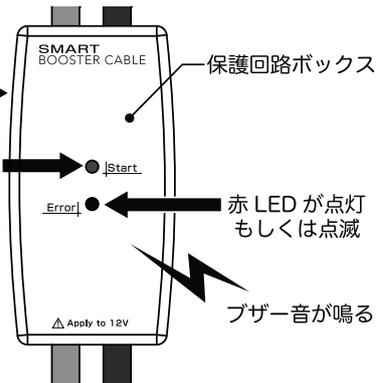
⑥ 保護回路ボックスの LED が緑 LED に点灯すると、ジャンプスタートの準備が完了した状態です。
