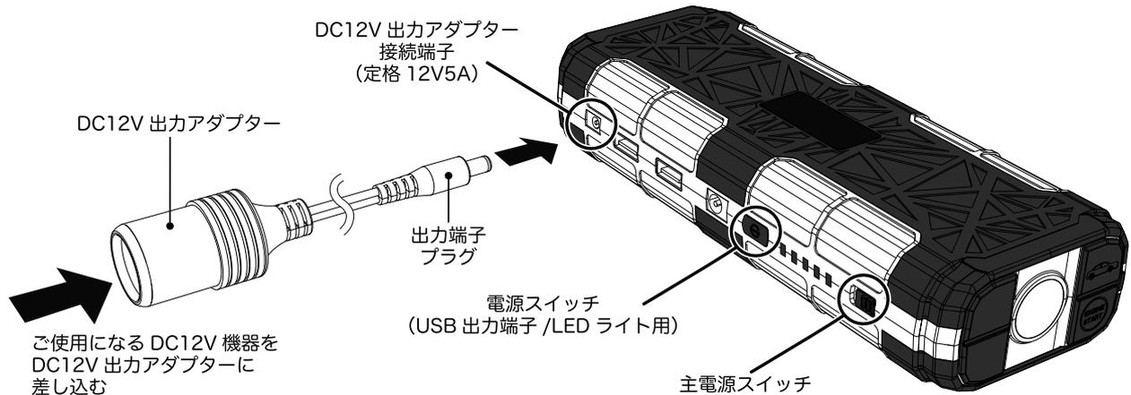
1. 製品本体の主電源スイッチを「ON」の位置へスライドさせ、電源スイッチ（USB 出力端子 /LED ライト用）を押します。
