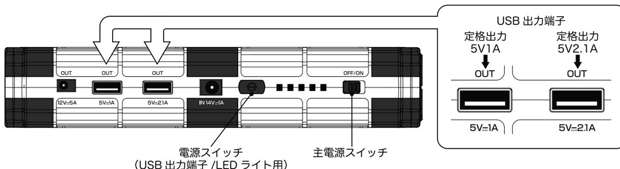
1. 製品本体の主電源スイッチを「ON」の位置にスライドさせます。
