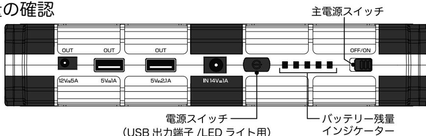
1. 製品本体の主電源スイッチを「ON」の位置にスライドし、電源スイッチ（USB出力端子 / LED ライト用）を押します。
