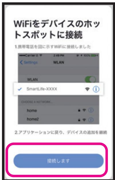
⑥「WiFiをデバイスのホットスポットに接続するために接続します」を選択します。
