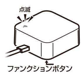
①本製品を電源に接続し、ファンクションボタンを6秒長押しLEDがすばやく(1秒に2回)点滅確認後、一度指を離し、再度ボタンを6秒長押しします。
