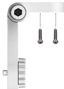
①取付部品をネジで固定します。
