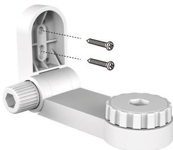
①取付部品をネジで固定します。
