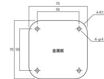
2. 設置場所がガラスや金属の場合は同梱の両面テープを使用します。金属板に同梱の両面テープ4枚を貼り、カメラを設置する場所に金属板を貼り付けます。石こうボード材に設置する場合は両面テープではなく、他社製の細い釘やピンなどを使いいただくことで天井や壁面などの目立たない穴でカメラを設置することができます。他社製の釘やピンをご使用する場合は使用前に取付方法などをご確認ください。他社製の部品のご使用による取付面の破損には当社はその責任を負いかねますので、あらかじめご了承ください。
