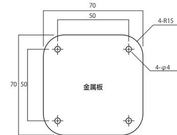
2.設置場所がガラスや金属の場合は同梱の両面テープを使用します。金属板に同梱の両面テープ4枚を貼り、カメラを設置する場所に金属板を貼り付けます。右こうボード材に設置する場合は両面テープではなく、他社製の細い釘やピンなどをお使いいただくことで天井や壁面などの目立たない穴でカメラを設置することができます。他社製の釘やピンをご使用の場合は使用前に取付方法などをご確認ください。他社製の部品のご使用による取付面の破損には当社はその責任を負いかねますので、あらかじめご了承ください。
