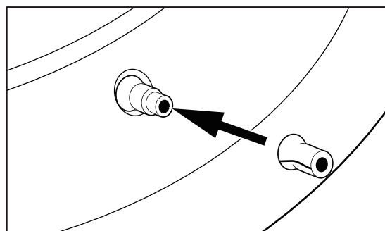
3. 本製品がしっかりとまっていることを確認し、エアバルブキャップを取付けます。取付け後に本製品が固定されていることを確認してください。
