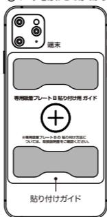
(図5) 貼り付け用ガイドに開いている穴にあわせて専用吸着プレートBを貼り付ける
