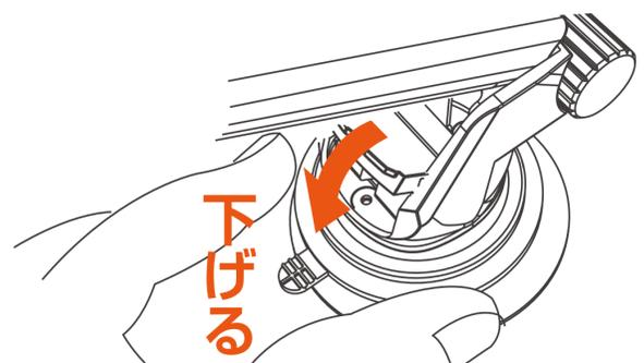
※ 車両から取外す際は、ダイヤルを緩めてレバーを上げてから、吸盤のベロ部分を持ち、吸盤をゆっくり剥がします。
