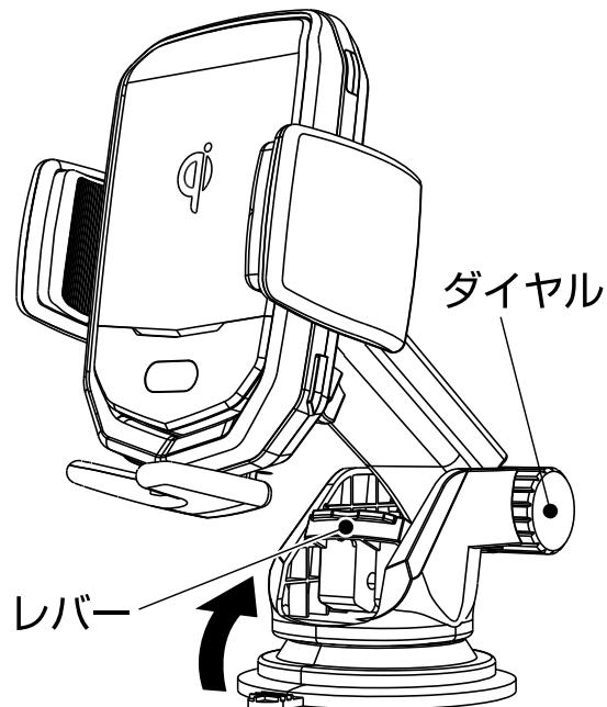
⑧吸盤を取り付けプレートに強く押し付けながらレバーを下げます。
