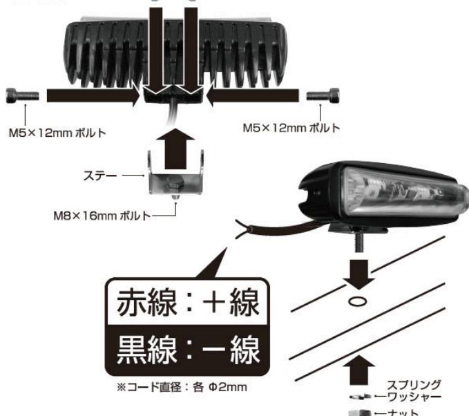
① 付属のステーの中央に M8×16mm ポルトを挿した後、ステーを本体背面に取付けます。次に本体の背面にナットを入れ、M5×12mm ポルトを左右から差し込み、ステーの角度を決め、4mm 六角レンチでポルトをしっかりと締めてください。
