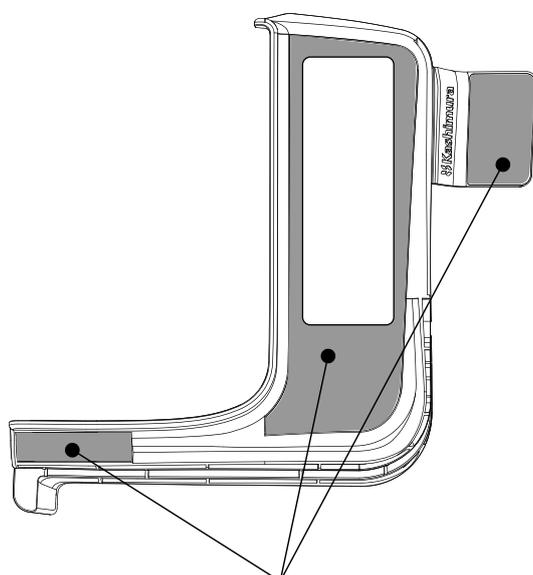
メーターパネルの左側に貼り付けて使用します。
