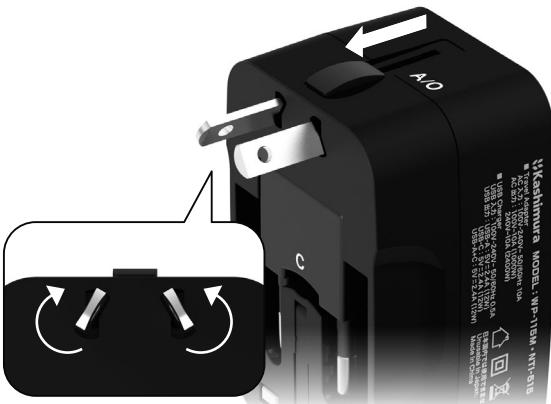
A/O印字側のボタンを軽く押しながら、白矢印の方向へスライドさせてください。左右の平型プラグを吹き出し図のように回転させて斜めにします。使用後はボタンを矢印の反対方向へ戻すと収納できます。
