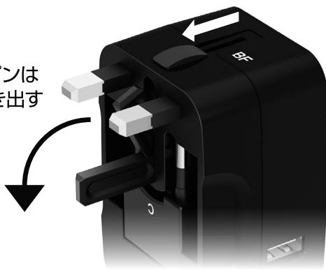
BF印字側のボタンを軽く押しながら、白矢印の方向へスライドさせてください。アースピンが少し出でますので指でつまんで引き出してください。使用後はボタンを矢印の反対方向へ戻し、アースピンは指で押して収納します。
