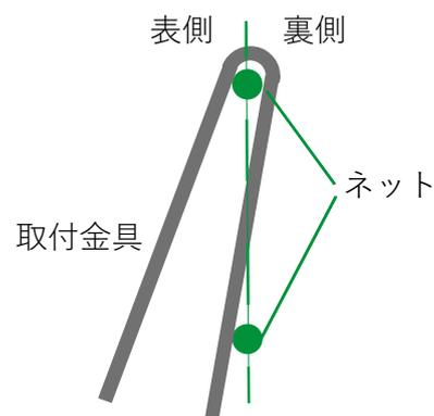
2. 立入禁止板の穴と、取付金具の穴を合わせ、表側（板側）からリベットを差し込み、ハンドリベッターで留めます
